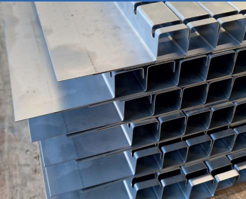
Ob für Terrassen oder Balkone – unsere massgefertigten Randabschlussprofile sorgen für eine saubere und stabile Einfassung von Plattenbelägen im Außenbereich. Die gelochte Ausführung garantiert perfekte Fixierung und Entwässerung.
