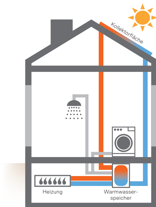
Solarthermieanlage für Brauchwarmwasser.
